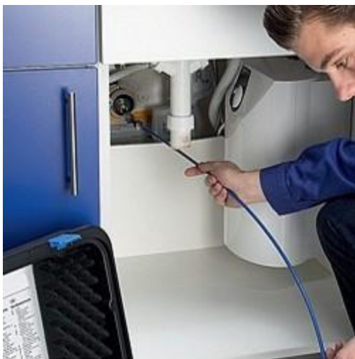
Das Videoskop lokalisiert spielend Beschädigungen, z.B. an Abwasserrohren / Fallrohren in Gebäuden.
