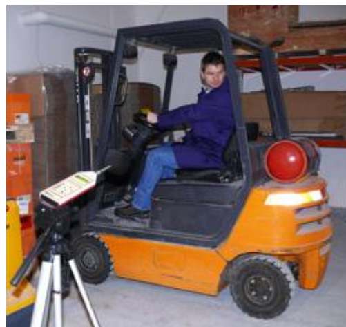
Messungen für die Beurteilung der Lärmbelastung am Arbeitsplatz
