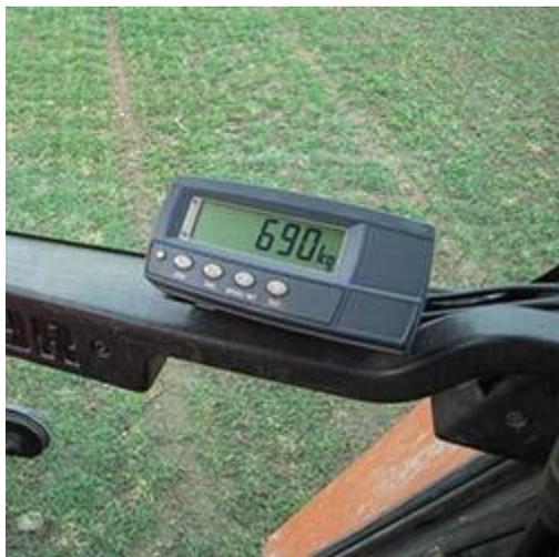
Hier sehen Sie das Display der Dreipunktwaage PCE-TCW 1. Messwerte lassen sich einfach während der Fahrt ablesen. Die Verteilung der Düngermengen oder andere Stoffe lassen sich somit optimal und bequem überwachen.
