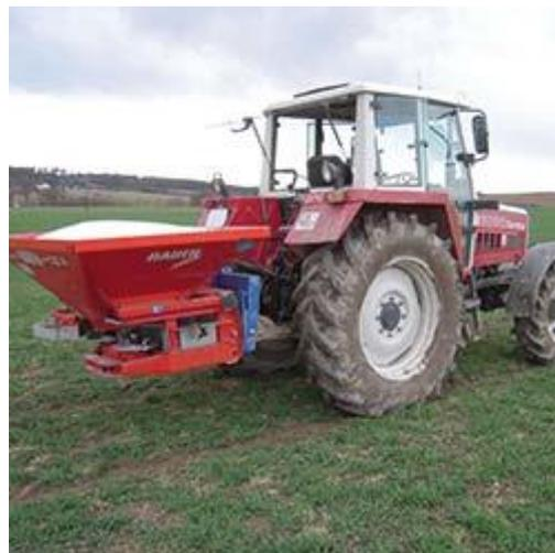
Hier sehen Sie die Dreipunktwaage PCE-TCW 1 in Aktion. Die Halterungsvorrichtung transportiert ein Behältnis mit Dünger. Der Fahrer vom Traktor kann jederzeit das Gewicht der Ladung überprüfen.
