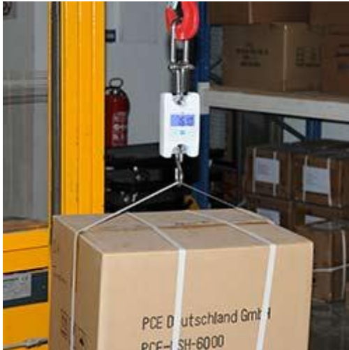
Digitale Hängewaage PCE-HS 150N beim Wiegen eines Kartons im Versand.
