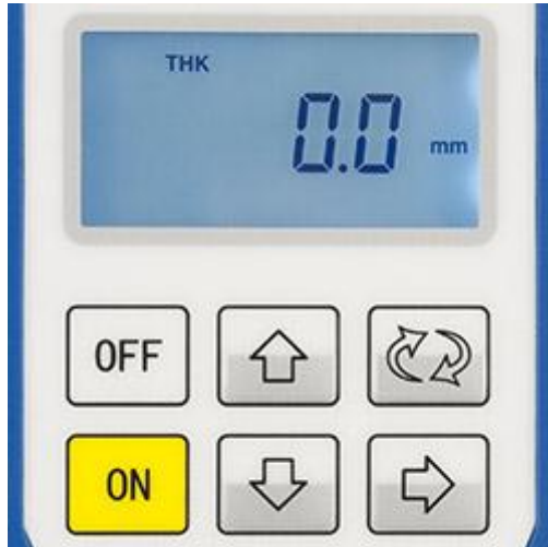
Hier sehen Sie das Messmenü des Dickenmessgerät
