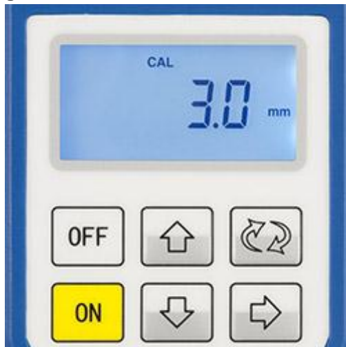
Hier sehen Sie das Dickenmessgerät im Kalibriermodus
