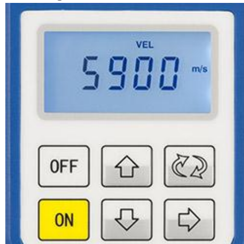
Das Dickenmessgerät befindet sich im Modus, wo Sie die Geschwindigkeit manuell einstellen können
