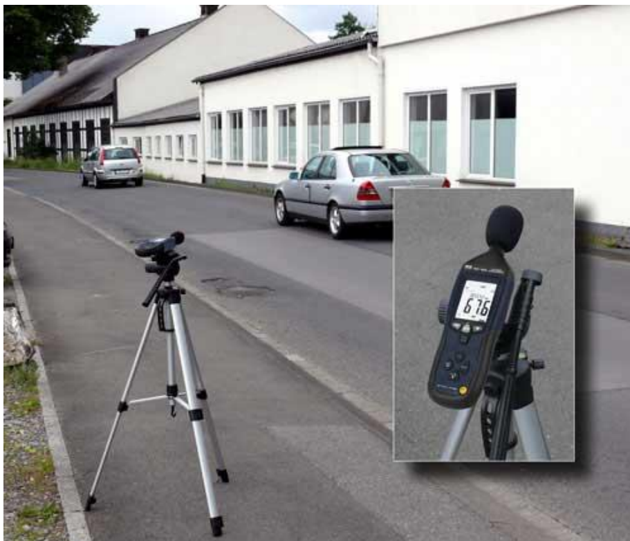
Schallmessgerät PCE-322A im Einsatz bei der Messung von Verkehrslärm (auf Stativ montiert)
