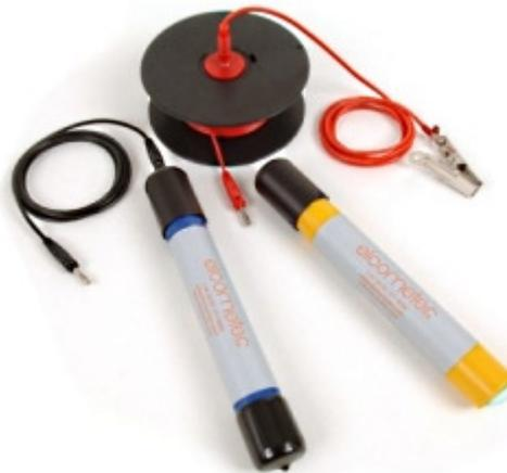
Hinweis zur Halbzellentechnologie: Zur Prüfung ob an einer Bewehrung möglicherweise Korrosionsschäden vorliegen, misst das System das elektrische Potenzial der Bewehrung. Tritt hier eine Abweichung auf, kann an dieser Stelle von einer korrosiven Schädigung ausgegangen werden.
