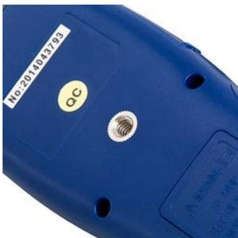
Mit dem Stativgewinde auf der Unterseite vom Windemesser PCE-VA 10 lässt sich das Gerät fixieren.
