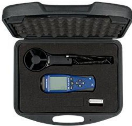
Der Windmesser PCE-VA 10 wird kalibriert in einem Koffer geliefert. Inbegriffen ist zum einen das Gerät selbst und die Sonde. Zudem werden auch noch Bedienungsanleitung und Batterie mitgeliefert.
