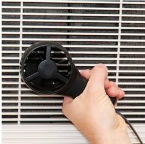
Hier sehen Sie den Sensor vom Windmesser PCE-VA 10, während einer Messung an einer Belüftungsanlage.
