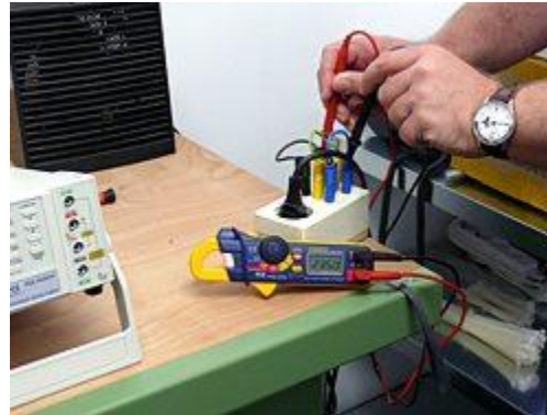
Amperemesser im Einsatz am Messplatz
