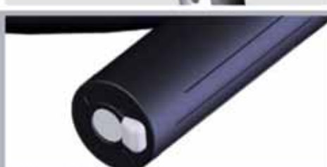
Sucher mit LED-Beleuchtung
