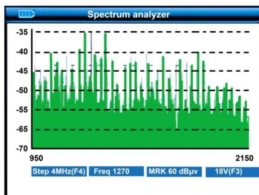
4. Mit Hilfe der Funktionstasten (F1 ... F4) und der Pfeiltasten (◀▶) können der Bereich des Spektrums (4 MHz ... 16 MHz), die Frequenz, sowie die angezeigte Signalstärke (-70 dBm ... 10 dBm) ausgewählt werden. Außerdem kann zwischen 13 V und 18 V umgeschaltet werden.
