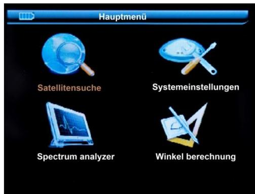
Drücken und halten Sie die POWER-Taste (14) um das Gerät einzuschalten. Sechs bis sieben Sekunden später erscheint das Hauptmenü. Vor der Erstbenutzung muss der Geräteakkumulator für ca. fünf Stunden geladen werden.
