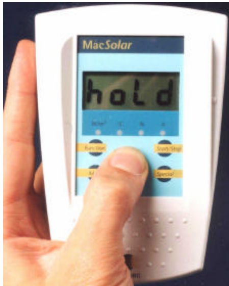
Fig. 5: Messung aktueller Werte mit dem MacSolar
