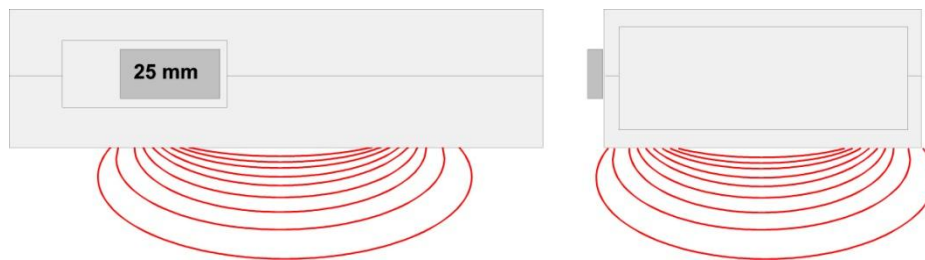
Seitenansicht: Messfeld und Eindringtiefe bei Schalterstellung „25 mm“
