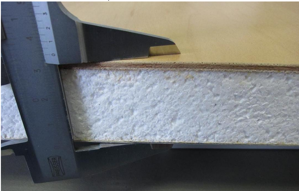
Beispiel Sandwich: Aluminium- Isolation - Sperrholz
