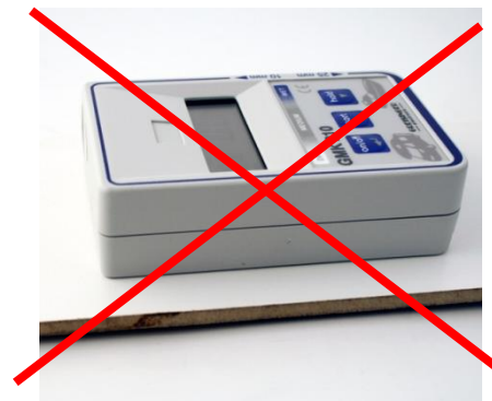
Falsch: zu geringe Materialstärke
