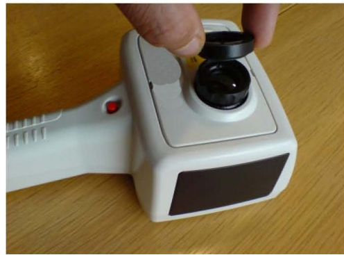
Nehmen Sie die Schutzkappe ab und setzen Sie den Filter auf
