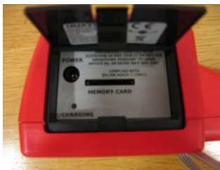
Bild 12 SD-Karte entnehmen und in den Leser einlegen
