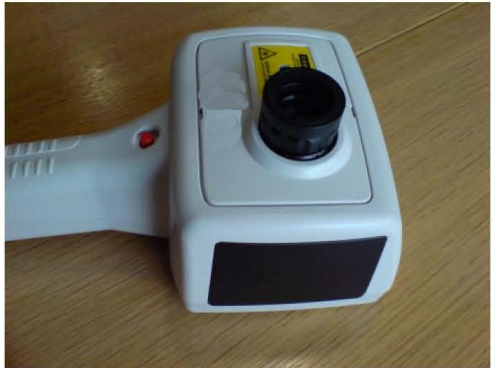
Der Filter ist nun fertig montiert.
