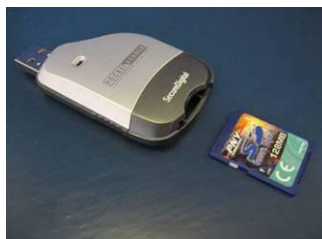
Bild 12 SD-Karte entnehmen und in den Leser einlegen
