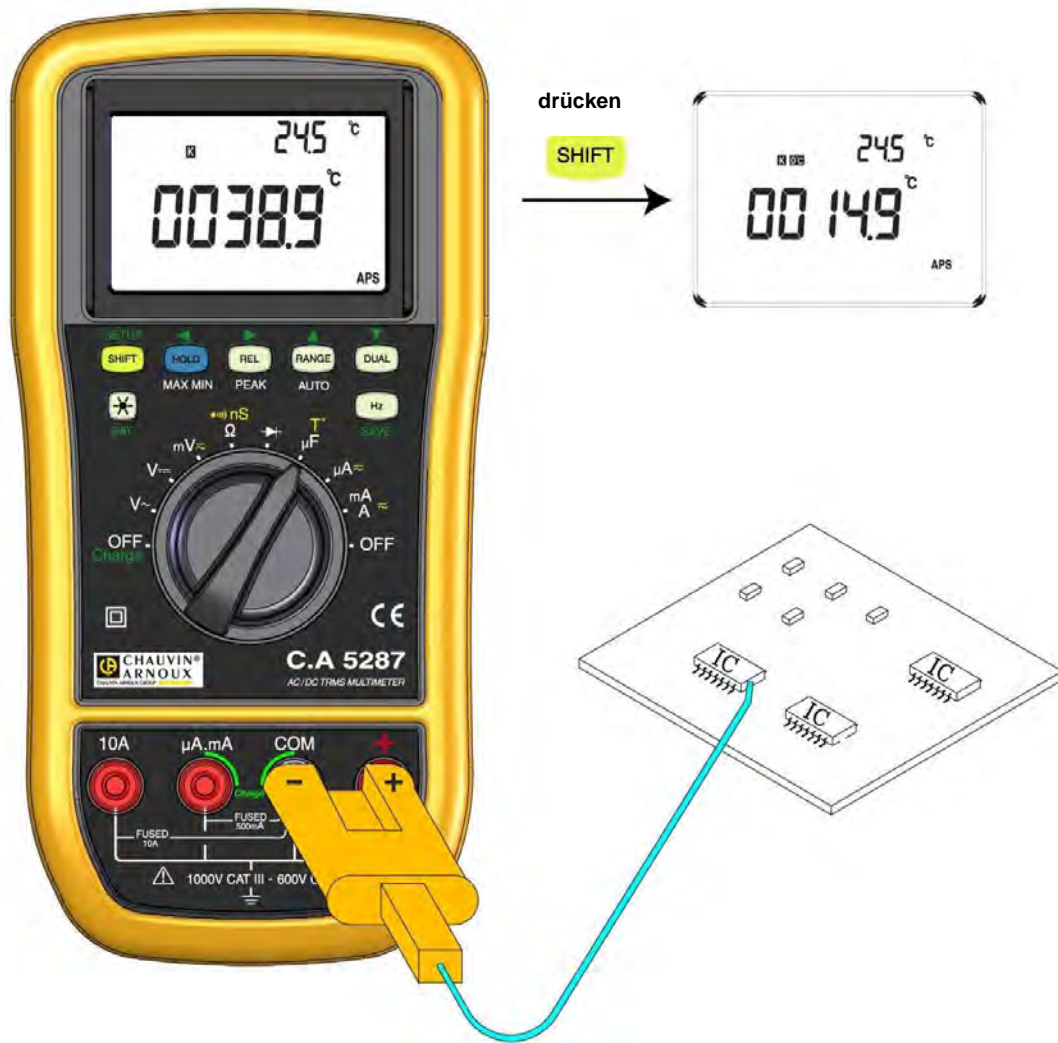
Abb. 50 – Messen der Oberflächentemperatur
