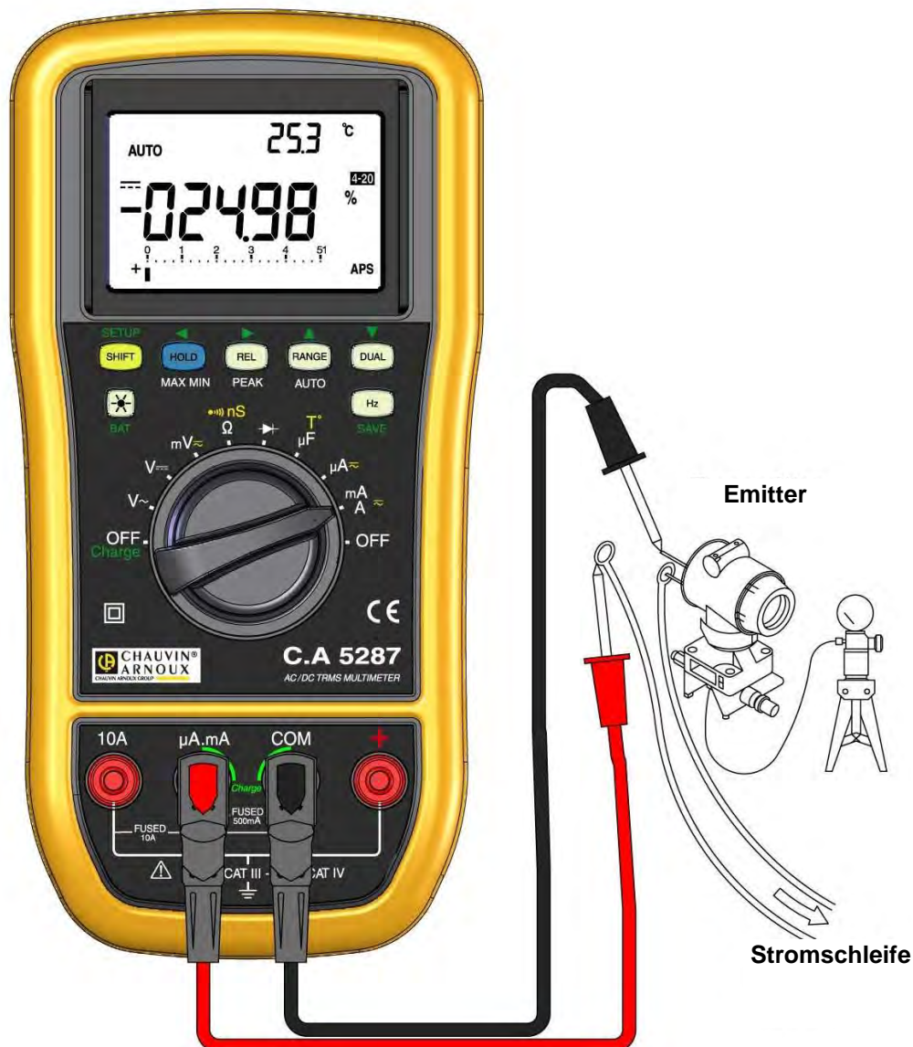
Abb. 42 - % Skala für 4-20 mA
