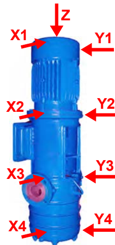
Bild 16: Messorte an Maschinen mit vertikalem Rotor
