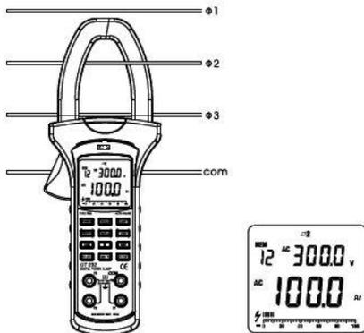
Um Wechselstrom / Wechselspannung zu messen, drücken Sie die Taste **MENU** so oft bis auf dem Display A / V angezeigt wird. Öffnen Sie die Messzange und umschließen den zu messenden Leiter mit der Messzange. Verbinden Sie mit den Messleitungen die Messbuchse V1-V3 mit dem zu messenden Leiter L1-L3 sowie den N Leiter mit der Messbuchse COM. Im Display können Sie jetzt den Strom und die Spannung ablesen.
