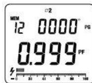
Zur Messung der Phase 2 drücken Sie die Taste **SELECT** bis Ø2 im Display erscheint
