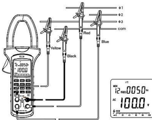
Um Wechselspannung / Frequenz zu messen verbinden Sie die Messleitungen mit dem Messgerät.
