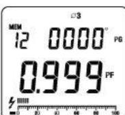
Zur Messung der Phase 3 drücken Sie die Taste **SELECT** bis Ø3 im Display erscheint.
