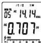
Drücken Sie die Taste **SELECT** zweimal sodass Ø1, Ø2, und ΣW im Display erscheint. Es wird die Leistungssumme der zwei Phasen angezeigt. Die Tasten **MAX▲** oder **MIN▼** schalten zwischen Leistung / Blindleistung und Leistungsfaktor / Scheinleistung um.
