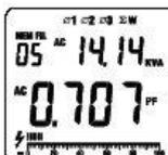
Drücken Sie die Taste **SELECT** sodass Ø1, Ø2, Ø3, und ΣW im Display erscheint. Es wird die Leistungssumme der drei Phasen angezeigt. Die Tasten **MAX▲** oder **MIN▼** schalten zwischen Leistung / Blindleistung und Leistungsfaktor / Scheinleistung um.
