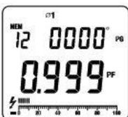
Zur Messung der Phase 1 drücken Sie die Taste **SELECT** bis Ø1 im Display erscheint.
