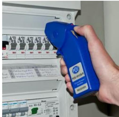
Einfach den Signalgeber in die Steckdose stecken und mit dem Empfänger die in der Wand liegende Leitung verfolgen.
