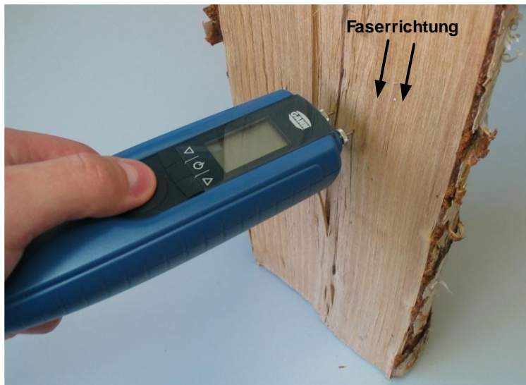
Abbildung 4-1 Messung quer zur Faserrichtung
