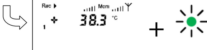
Das Display zeigt die Temperatur in Grad °C, Kanal Nummer, Messeinheit und Speicher Status. Die grüne LED leuchtet jede Minute.
