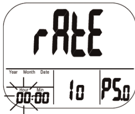
Abb. 19: Einstellen der Abtastrate (Stunden)
