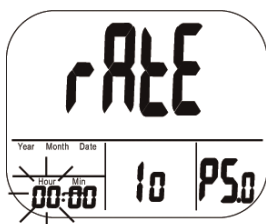
Afb. 17: Instellen van de aftastfrequentie (uren)
