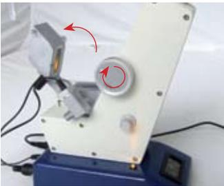
Den Verriegelungsknopf im Uhrzeigersinn drehen und das Beleuchtungsprisma anheben. Einige Tropfen Kontaktflüssigkeit auf das Messprisma geben. Den Kalibrierkörper mit der polierten Fläche auf das Messprisma legen. Dabei dürfen keine Luftblasen zwischen Kalibrierkörper und Messprisma eingeschlossen werden.
