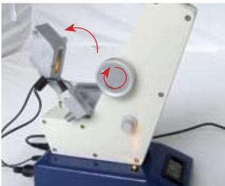
Das Beleuchtungsprisma durch Drehen des Verriegelungsknopfes aufklappen. Ein oder zwei Tropfen der Flüssigkeit werden auf das Messprisma gegeben, das Beleuchtungsprisma wieder heruntergeklappt und mit dem Knopf geschlossen.
